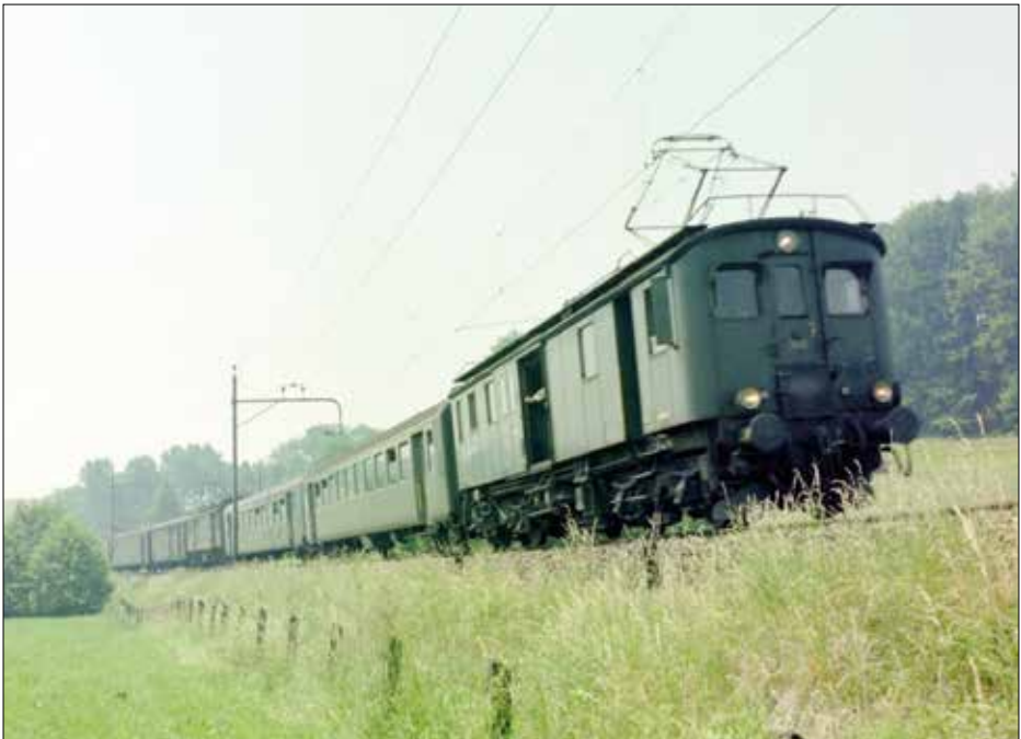
Güterzug mit zwei Gepäcktriebwagen De 4/4, Einheitswagen EW 1 und Leichtstahlwagen auf der Strecke Sulgen – Gossau, 1976.
